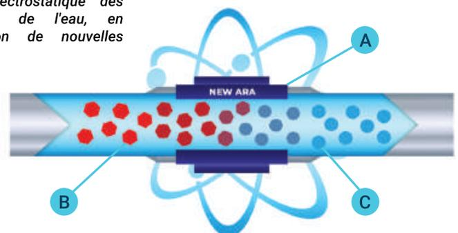
Quand l'eau traverse le dispositif, la structure moléculaire des divers minéraux qui sont présents dans l'eau, est modifiée de telle façon que les molécules de ces minéraux ne s'agglomèrent plus en empêchant la formation d'incrustations. En particulier, l'intense champ magnétique produit par l'accélérateur ionique **NEW ARA** transforme les éléments carbonatés en très petits cristaux d'aragonite, qui sont éliminés par le dynamisme de l'eau.
